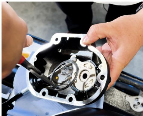
5. Löse alle Schrauben des Kupplungsdeckels und entnehme das originale Kupplungssegment mittels einer Sprengringzange.
