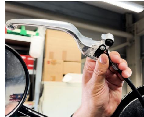
6. Demontiere den Kupplungshebel von der Armatur.
