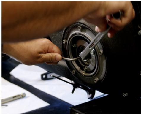
4. Öffne den Kupplungsinspektionsdeckel des Primärkettengehäuses, löse die Kontermutter der Einstellschraube und entspanne diese.
