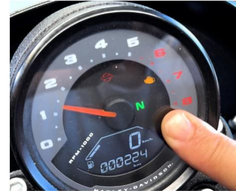
23. Versuche im Stand, ob du vom Leergang in den 1. Gang schalten kannst und wieder zurück. Falls das einwandfrei funktioniert, kannst du die erste Probefahrt machen. Falls die Kupplung sauber trennt und sich die Gänge gut schalten lassen, ist die Montage abgeschlossen.
