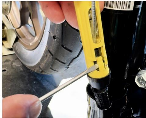
8. Öffne mit Hilfe eines Schlitzschraubenziehers die Klemmung des Bowdenzugspanners und entferne das untere Segment des Spanners.
