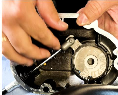
13. Baue nun das neue Power Clutch 2.0 Segment in den Kupplungsdeckel und übernehme die drei originalen Kugeln vom alten Kupplungssegment.
