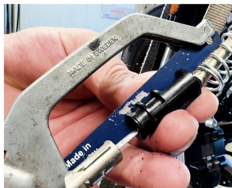
10. Entferne mit Hilfe einer kleinen Handsäge das schwarze Gegenstück des Bowdenzugspanners und fädel den Bowdenzug aus.
